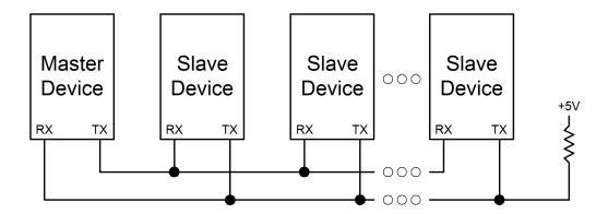
Figure 21.7. UART Multi-Processor Mode Interconnect Diagram
