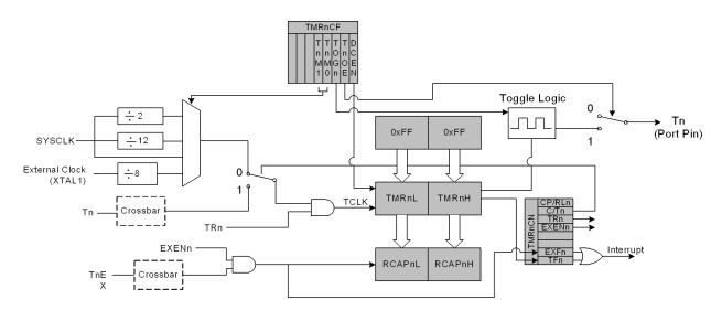
Figure 23.4. Tn Capture Mode Block Diagram
