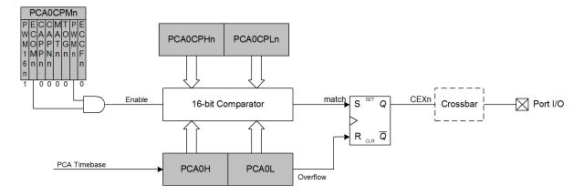
Figure 24.9. PCA 16-Bit PWM Mode
