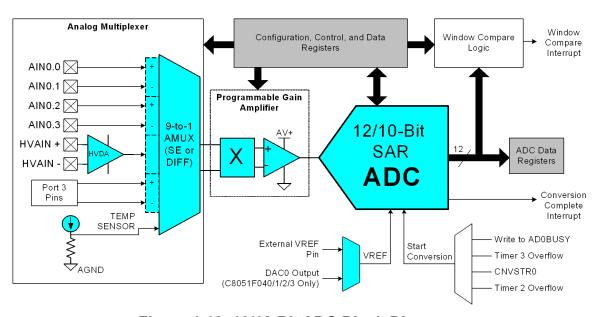
Figure 1.12. 10/12-Bit ADC Block Diagram
