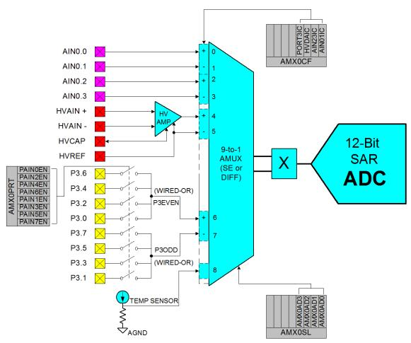
Figure 5.2. Analog Input Diagram
