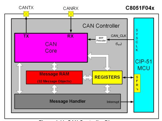
Figure 1.11. CAN Controller Diagram
