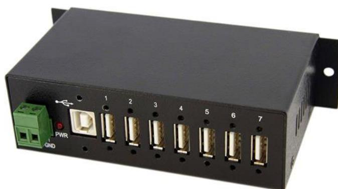
L'hub USB 2.0, resistente, di tipo industriale, può essere montato a parete o installato su una guida DIN per un facile accesso alle 7 porte USB 2.0 femmina, fornendo connettività USB 2.0 a un'area di lavoro, una stanza server o un'area industriale.
