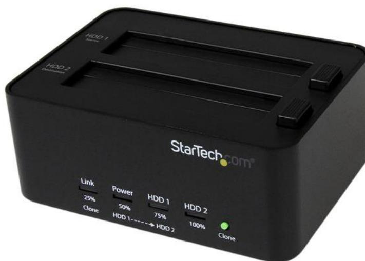
Il duplicatore ed eraser indipendente USB 3.0 SATDOCK2REU3 permette di collegare dischi rigidi SATA da 2,5"/3,5" o unità a stato solido mediante SuperSpeed USB 3.0 con la possibilità di inserire ed estrarre i dischi rigidi secondo necessità. La docking station funziona inoltre come duplicatore ed eraser di dischi indipendente: una soluzione efficiente e versatile per la gestione delle unità esterne.
