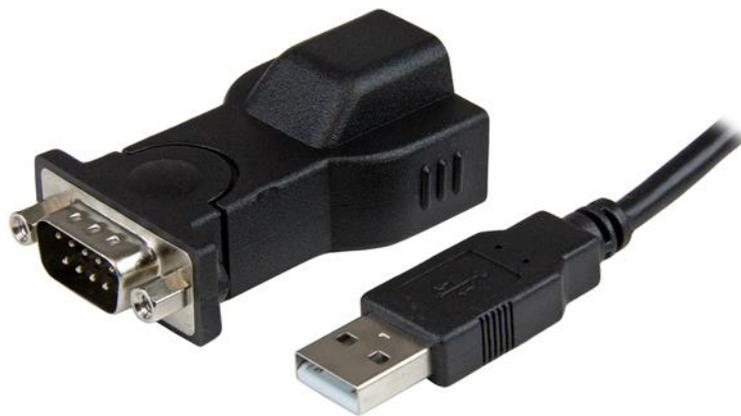
L'adattatore USB a seriale a 1 porta ICUSB232D consente di aggiungere una porta seriale DB9 RS232 al laptop o a 1 computer desktop mediante USB, in modo da poter collegare, monitorare e controllare un dispositivo seriale. Per collegamenti semplici, l'adattatore presenta una porta USB di tipo B femmina, quindi è possibile scegliere la lunghezza del cavo USB necessario per raggiungere il dispositivo seriale (cavo USB A-B da 1,8 m incluso).
