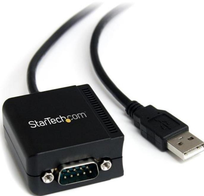
Il cavo adattatore USB FTDI a RS-232 seriale 1 porta ICUSB2321F con isolamento ottico consente di convertire una porta USB 1.1 o 2.0 in una porta DB9 RS-232 e può essere utilizzato per collegare, monitorare e controllare i dispositivi seriali.
